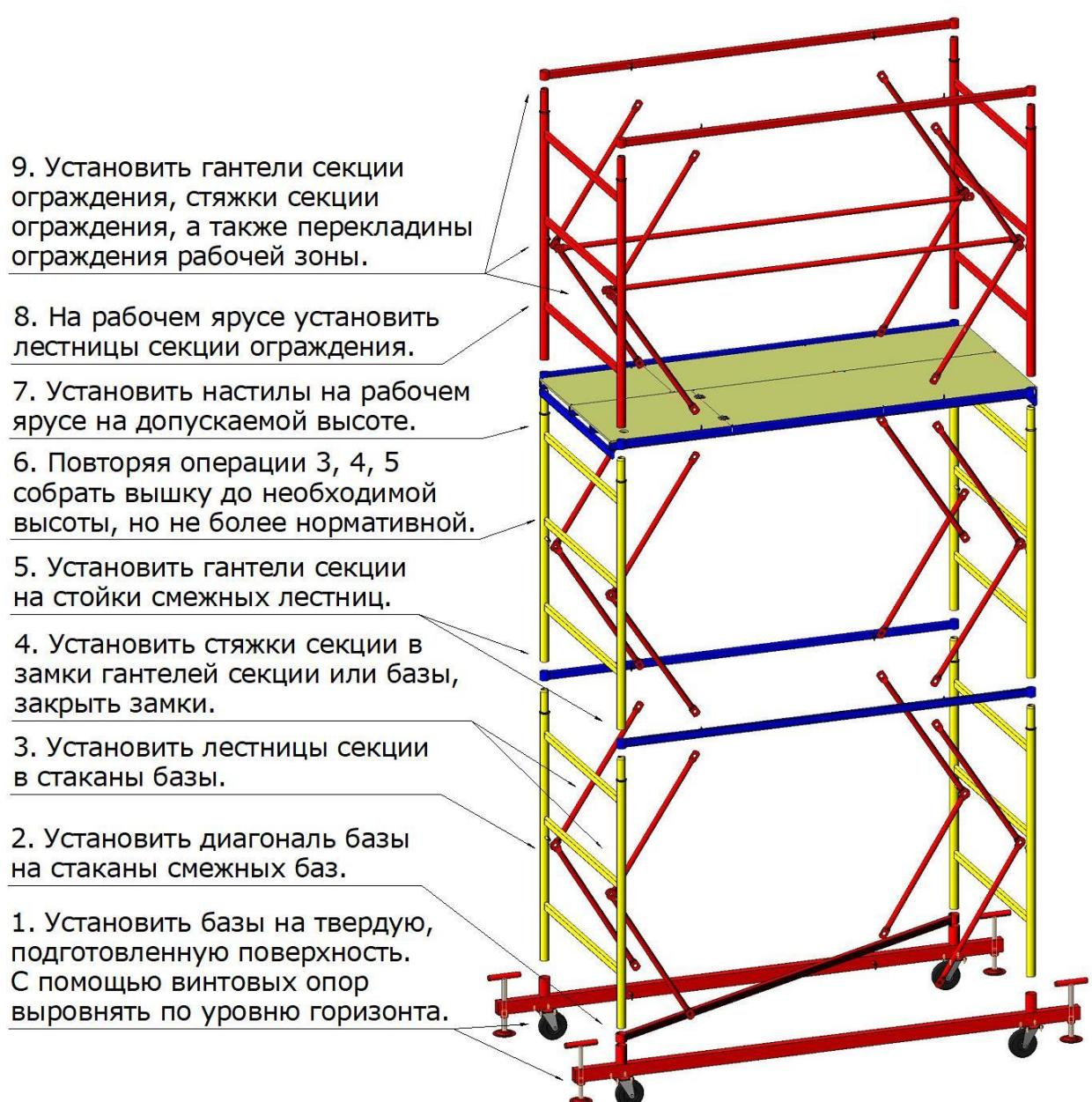
При сборке вышки высотой более четырёх секций, у основания необходимо установить и закрепить стабилизаторы (не входят в комплект поставки) для дополнительной устойчивости.
