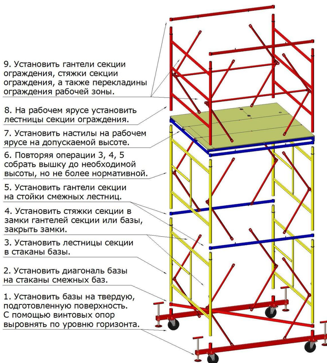
При сборке вышки высотой более четырёх секций, у основания необходимо установить и закрепить стабилизаторы (не входят в комплект поставки) для дополнительной устойчивости.
